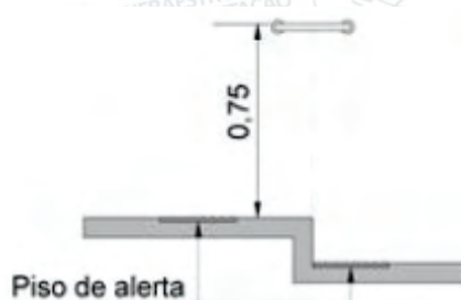
Figura 117. Barra de apoio horizontal
