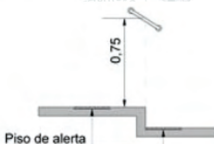
Figura 115. Barra de apoio inclinada
