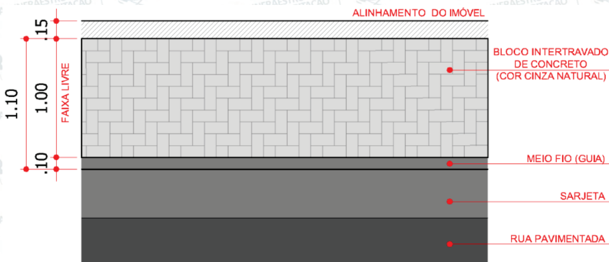
Figura 10. Calçada menor que 1,20m - Planta Baixa
