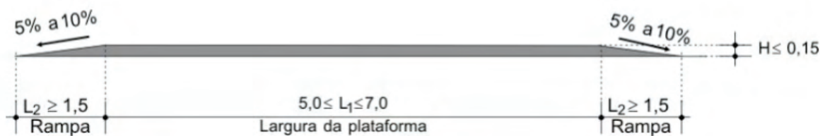
Figura 53. Corte Longitudinal - Faixa Elevada para Pedestres
