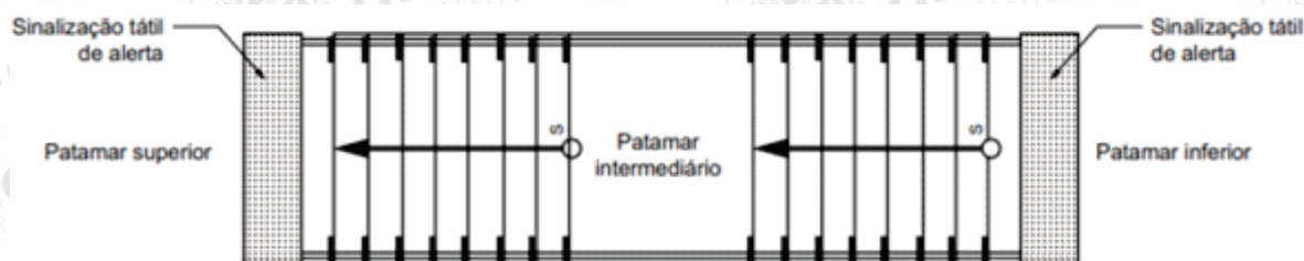
Figura 109. Patamares de escadas e rampas contínuas
