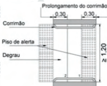
Figura 118. Corrimão lateral em degrau isolado com dois degraus
