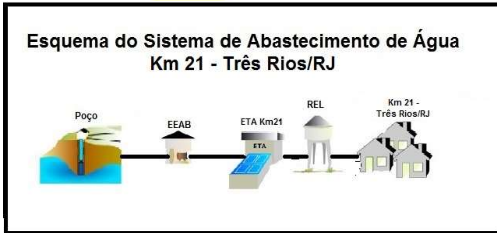
Figura 180 – Esquema gráfico do Sistema de Abastecimento de Água do Km 21
