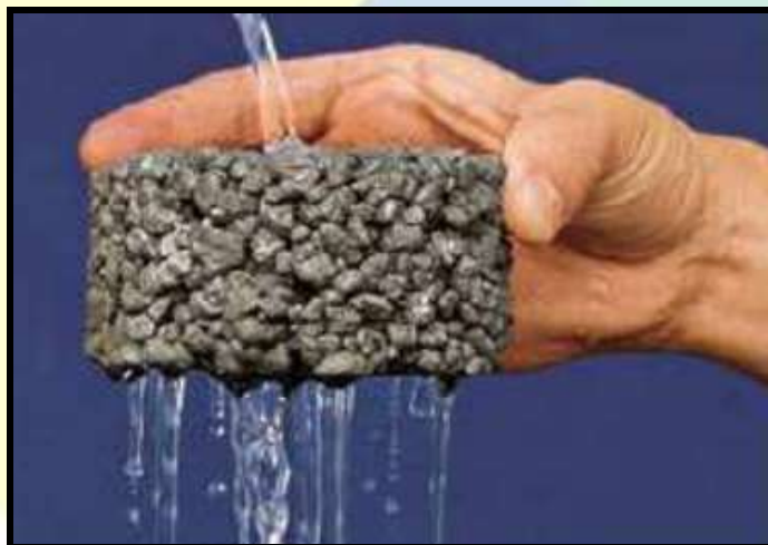
Figura 8 - Dispositivo de Controle de escoamento – Pavimento Poroso
