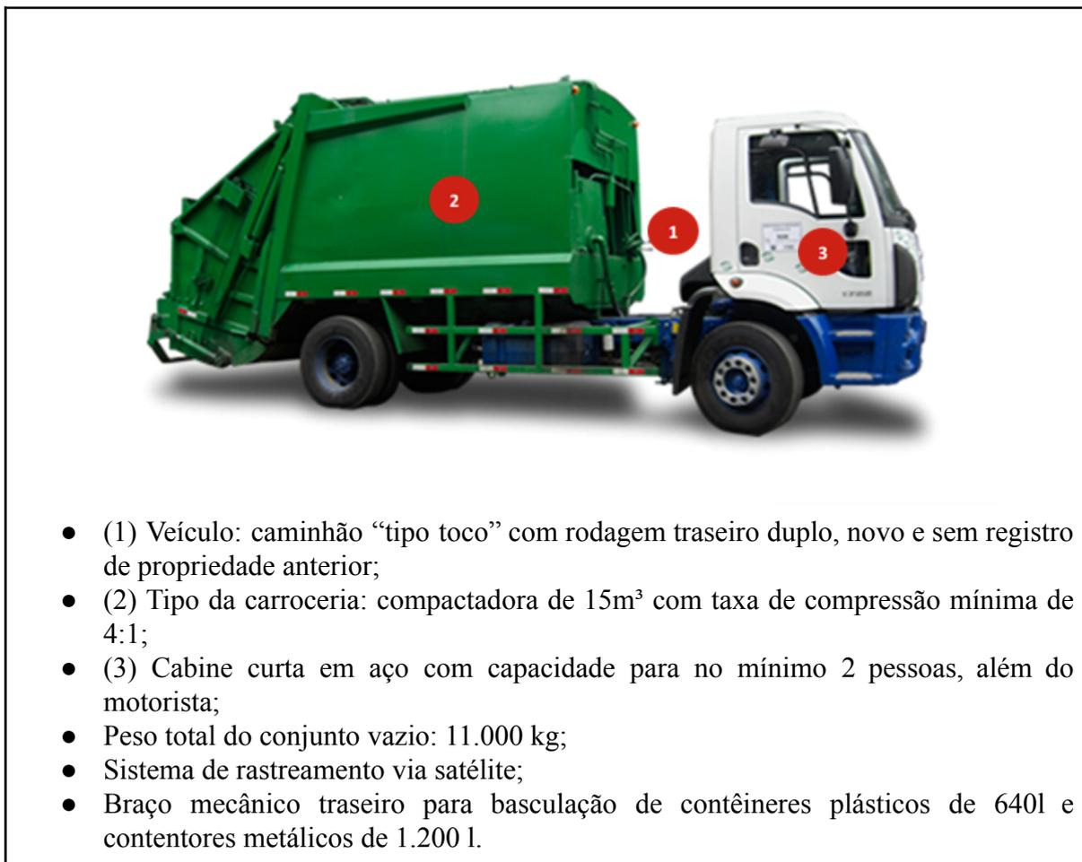
Figura 25 - Característica básicas recomendadas do veículo para coleta de rejeitos (Canal Cinza)
