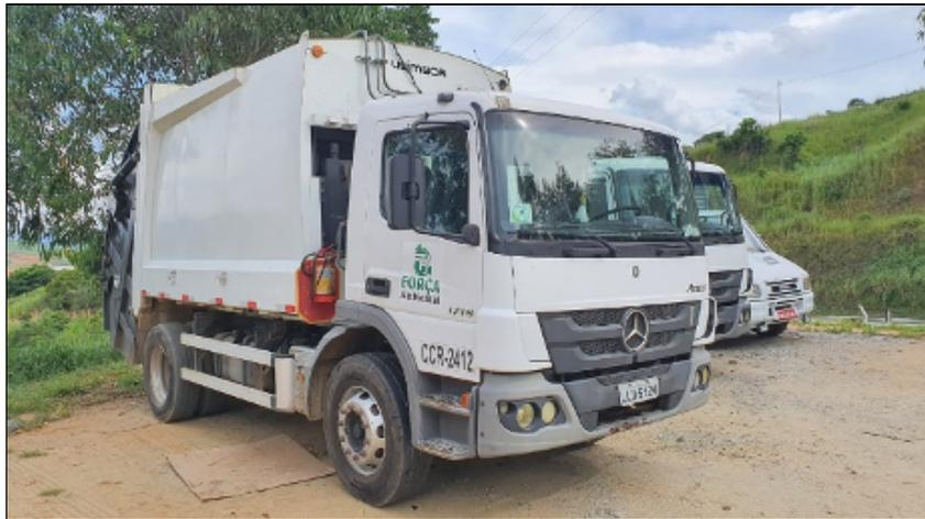
Figura 8 - Caminhão compactador (coleta de rejeitos)
